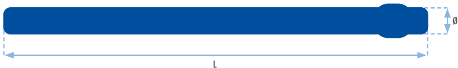
Bandsplinte mit Presssitz Stamped bracelet pins
