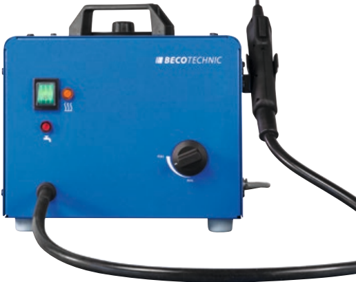
Dampfstrahlgerät Das kompakte Gerät erzeugt 4 bar Arbeitsdruck mit 150 °C, der über das Handstück abgegeben wird. Der Dampf wird aus destilliertem Wasser erzeugt.
